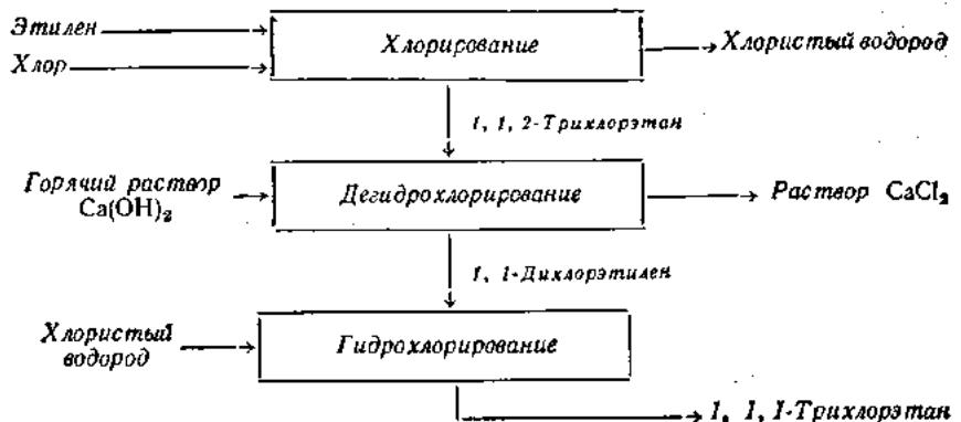
Рис. 12.8. Схема производства 1,1,1-трихлорэтана из этилена через винилиден-хлорид (фирма PPG Industries).
